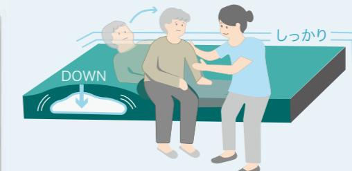
ご利用者様の起きあがりやマットレス端部への寝返り、端座位を検知し、マットレス全体の内圧を自動で上げてかたくします。膨らんでいた4つのスモールフローセルは自動で縮みます。
