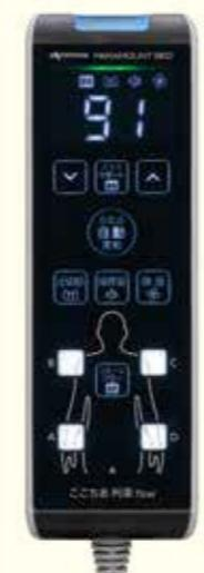
電源を入れるとたとえ自動運転機能がスタートするため、特に操作は不要です。操作パネルでは、スマートフロー設定ボタンを押して個別にセルの動作を中止させたり、しっかりモードボタンを押して任意のタイミングでマットレスをかたくすることができます。
